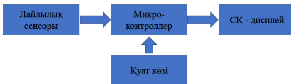
4.1 - сурет – Лайлылықты өлшеуге арналған аспаптың функционалдық сұлбасы
